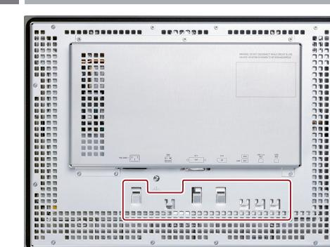
Sichern Sie die angeschlossenen Leitungen zur Zugentlastung mit Kabel-bindern an den markierten Befestigungselementen.
