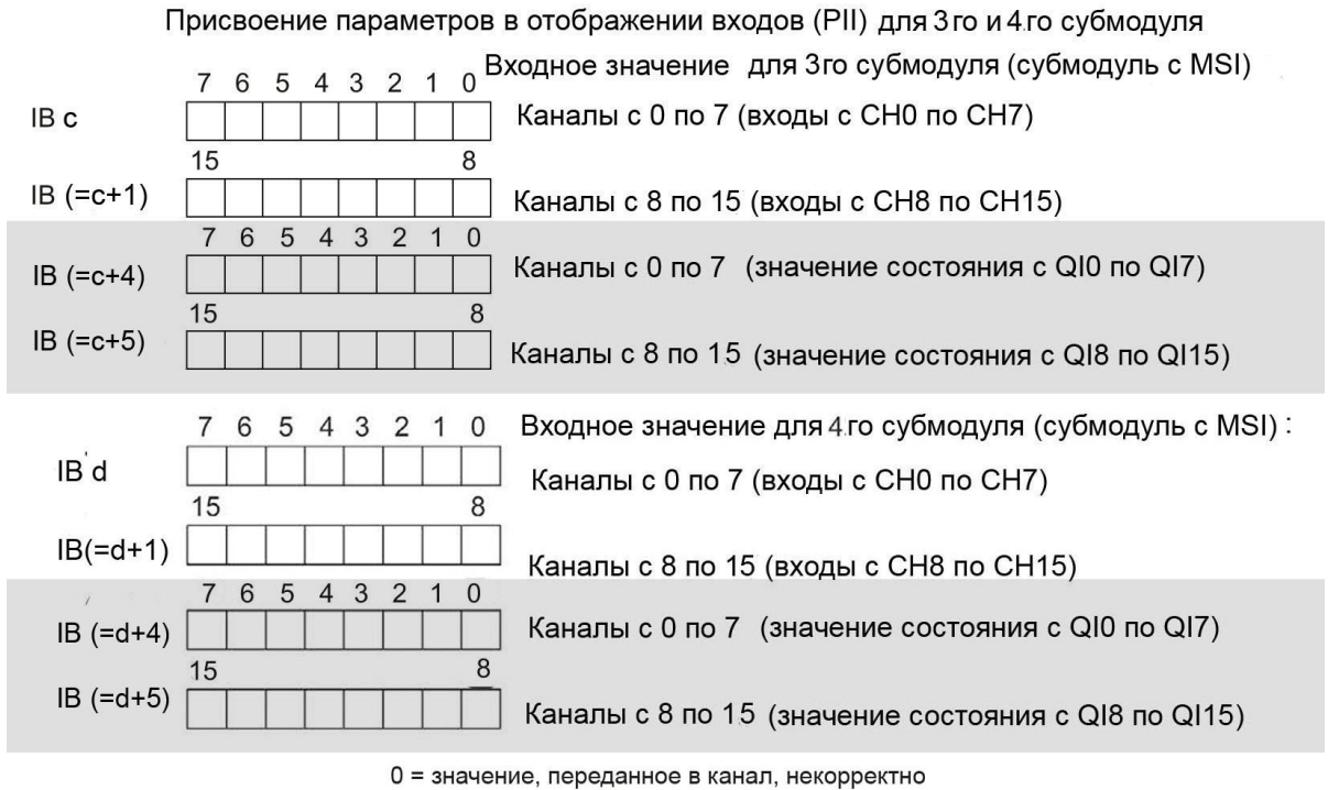
Рисунок 4-4 Пространство адресов при конфигурации модуля DI 16x230V AC BA MSI в режиме совместного доступа 1x16ти канального входа.
