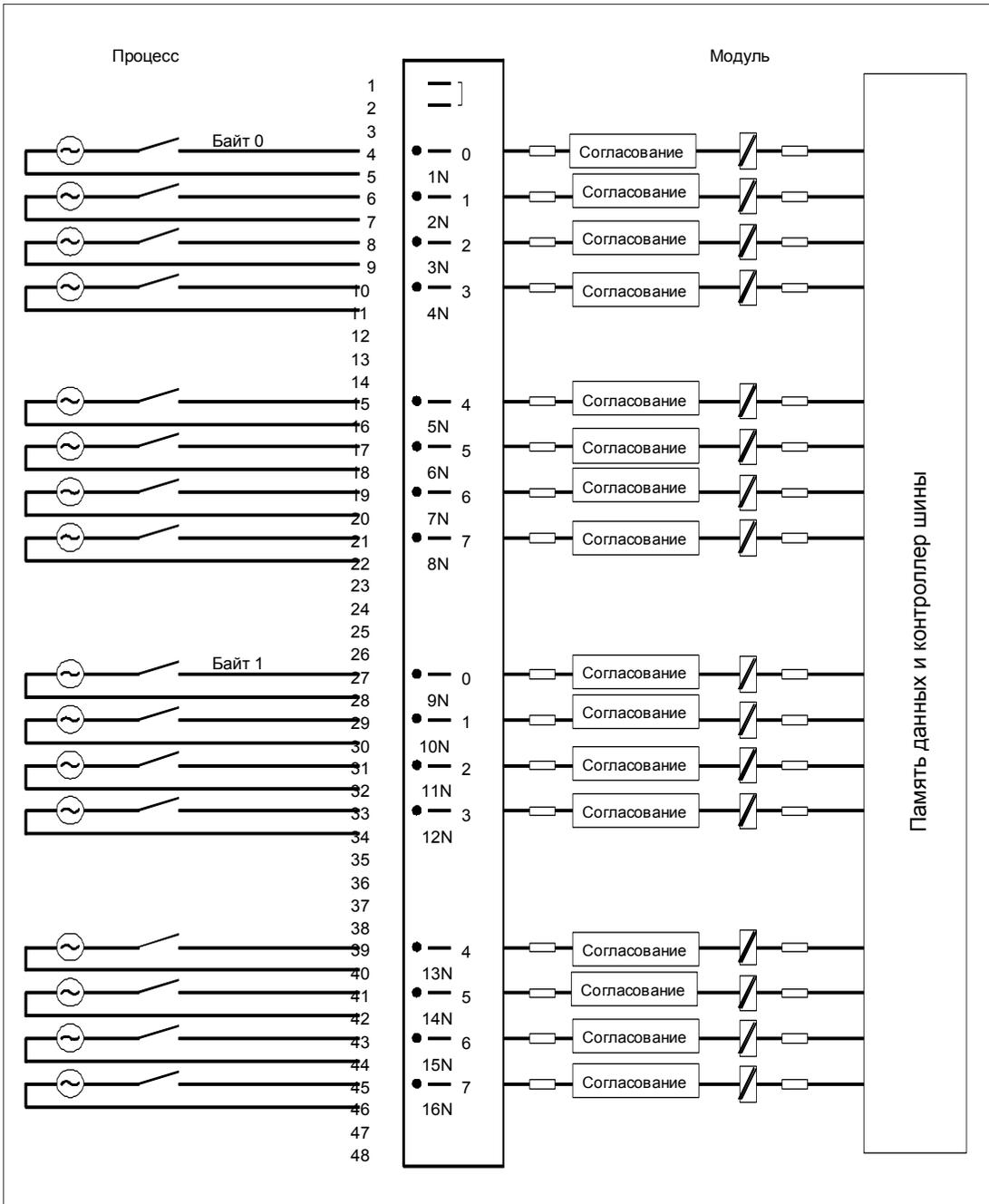
Рис. 4–8. Схема подключения SM 421; DI 16 x 120 VAC
