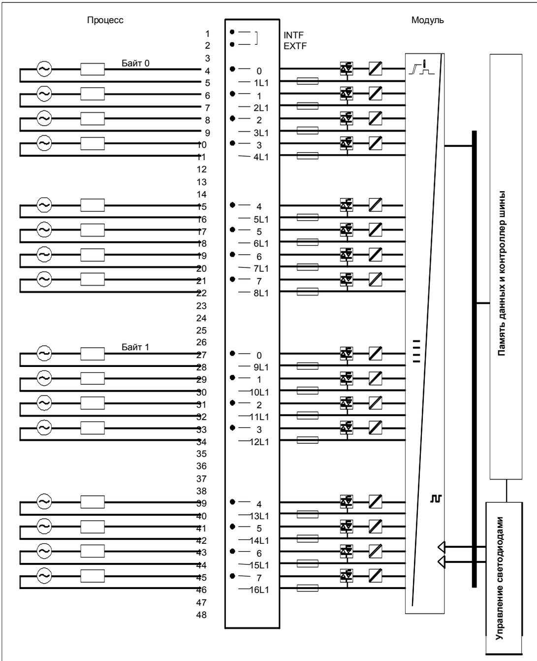
Рис. 4–21. Схема подключения SM 422; DO 16 x 20–120 VAC/2 A
