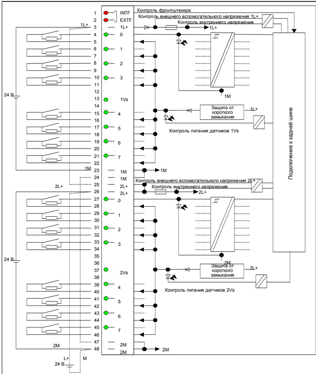
Рис. 4–4. Схема подключения и принципиальная схема SM 421; DI 16 x 24 VDC
