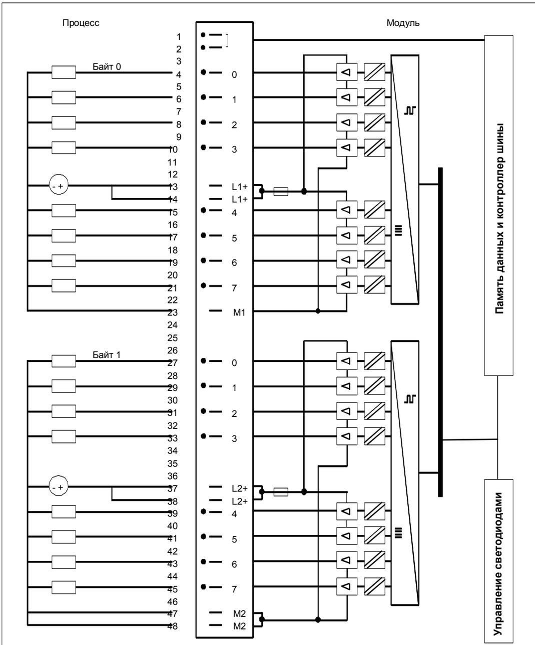
Рис. 4–16. Схема подключения SM 422; DO 16 x 20–125 VDC/1.5 A
