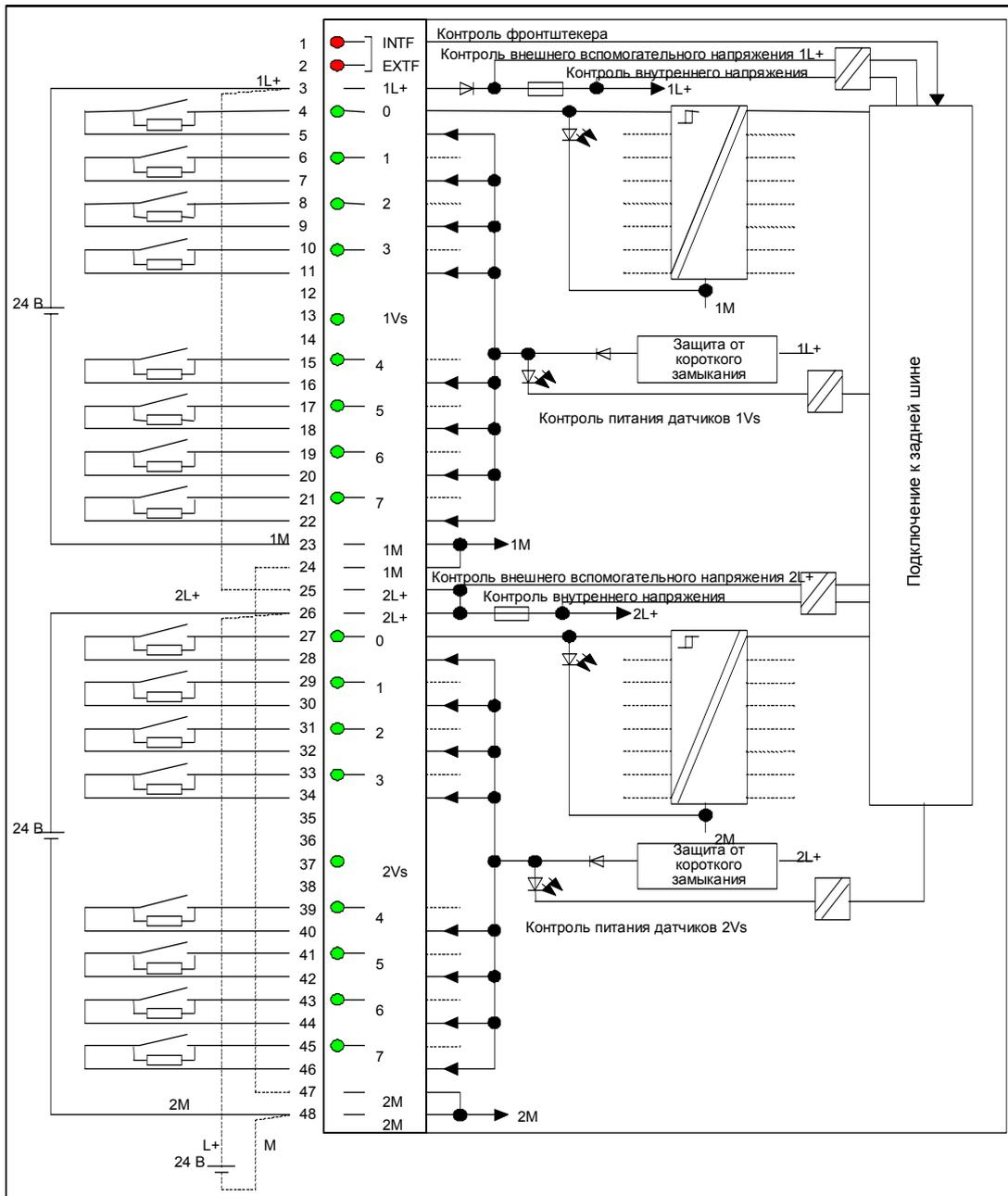
Рис. 4–6. Схема подключения и принципиальная схема SM 421; DI 16 x 24 VDC
