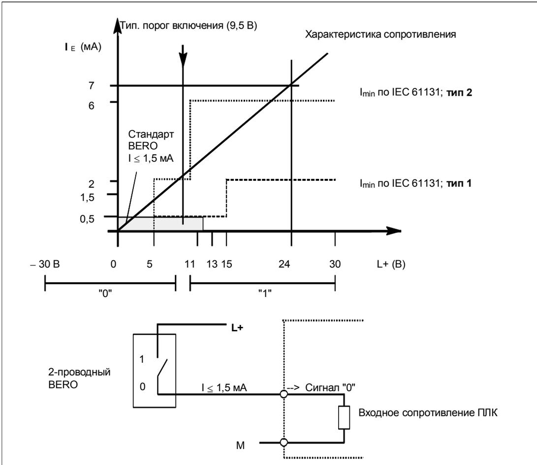
Рис. 4-1 Входная характеристика цифровых входов
