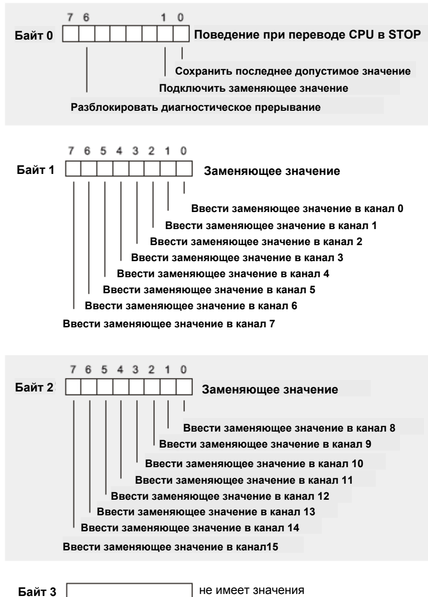
Рис. А-2. Запись данных 1 для параметров цифровых модулей вывода
