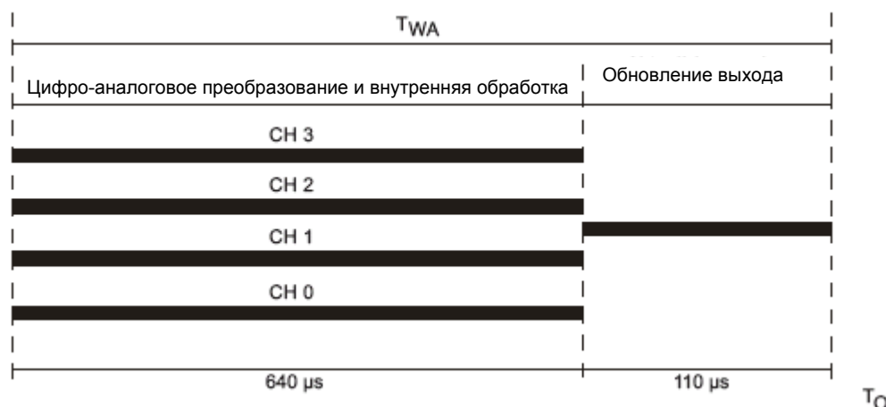
Рис. 6-36. Расчет времени обработки и времени обновления выхода
