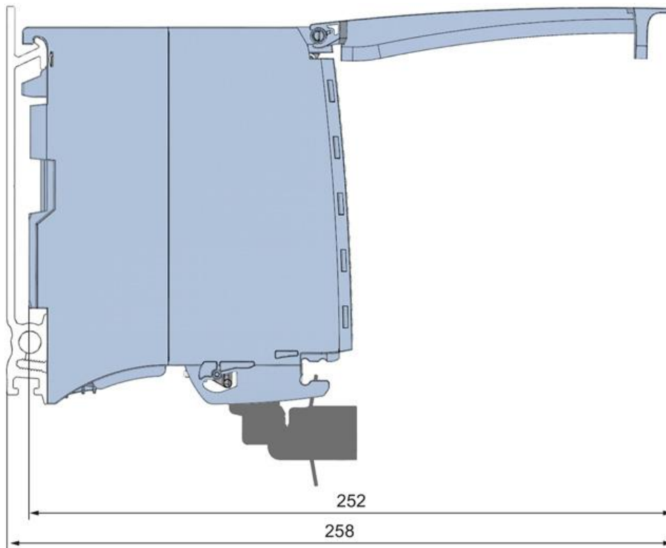
Рис. А-2 Габаритный чертеж модуля AQ 4xU/I ST, вид сбоку с открытой передней панелью
