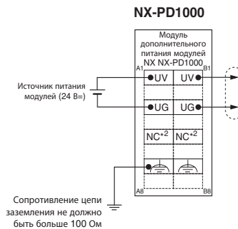
Схема подключения клемм
