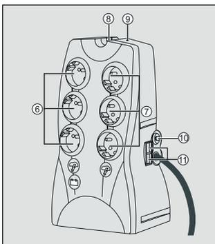
► **Розетки с аккумуляторной поддержкой ⑥:** Соединенные с этими розетками приборы запитаны, когда кнопка ⑧ нажата (положение включения) и ее зеленая подсветка горит (см. Рис. Е). Эти розетки можно включить, даже если АБП не соединен с сетью электропитания (при этом подсветка кнопки ⑧ мигает).
