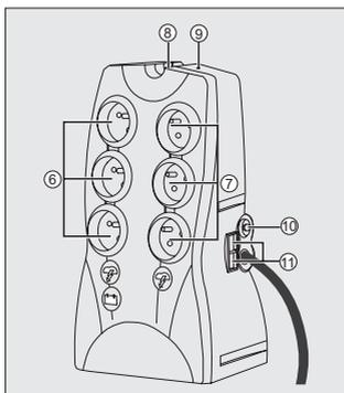
▶ Gniazda z filtrem ⑦ niezabezpieczone urządzenia podłączone do tych gniazd s ą zasilane od chwili, gdy przewód wej ściowy ② jest podłączony do gniazda ściennego. Przycisk ⑧ nie steruje tymi gniazdami.
