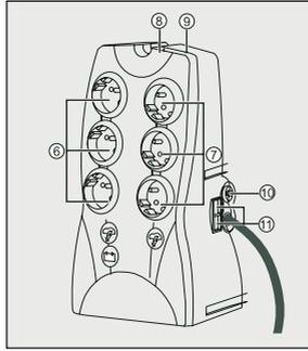
سكنر، فاكس...) بالمآخذ ⑦ المزود بفلتر والحمي ضد التيار العالي. انظر الرسم B. ولا يكون هذا المآخذ مشحوناً في حال انقطاع التيار الكهربائي.
