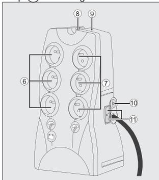
► **Battery backup-aansluitingen** ⑥: de apparaten die op deze aansluitingen aangesloten zijn, krijgen stroom van zodra de knop ⑧ ingedrukt wordt (AAN) en groen oplicht (zie figuur E). Deze aansluitingen kunnen ook ingeschakeld worden als de **UPS** niet op de netspanning aangesloten is (knop ⑧ knippert).
