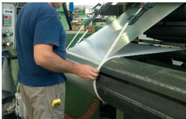
Изготовление обмотки низкого напряжения
