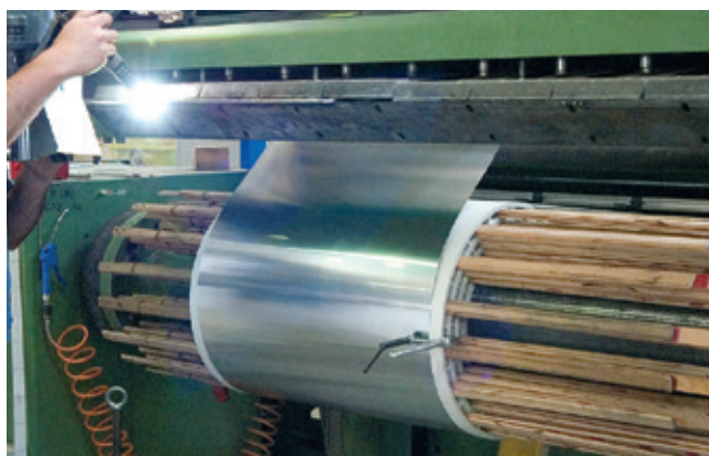
Сварка выводов обмотки низкого напряжения вольфрамовым электродом в среде инертного газа.
