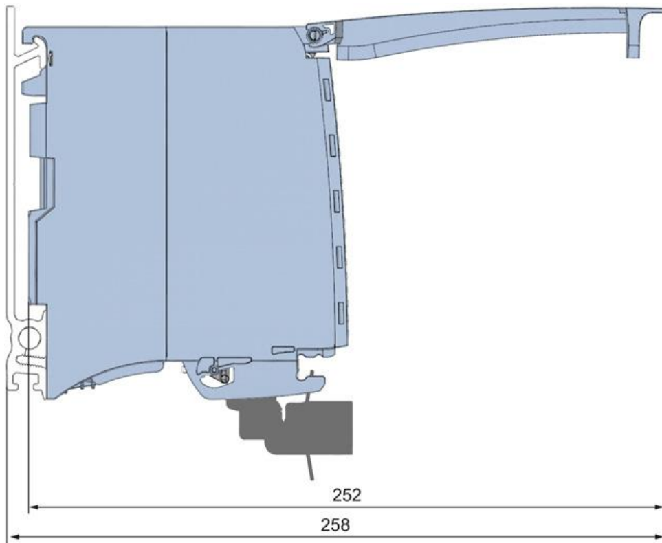
Рис. А-2 Габаритный чертеж модуля AQ 8xU/I HS, вид сбоку с открытой передней панелью
