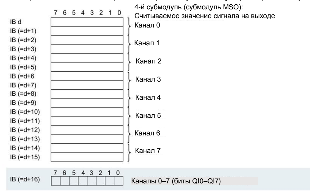
Рис. 4-4 Адресное пространство для конфигурации 1 x 8 канал AQ 8xU/I HS MSO с регистрацией информации о качестве
